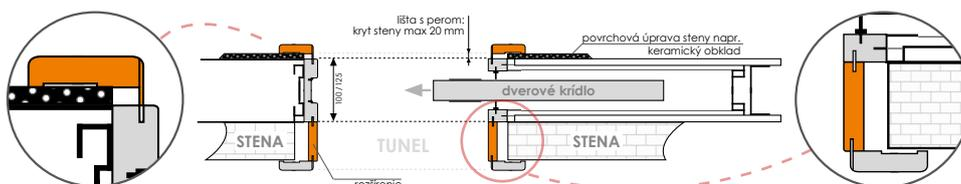
Šírka v rozsahu nad 20 mm sa nastavuje tak, že sa rozšíria jednotlivé komponenty rámu dverí – tunel (priplatok).
